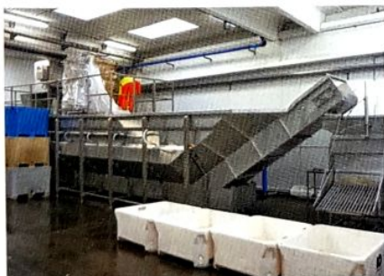
ITS-Auftauanlagen sind in drei Baugrößen von 1 bis 4 t Fisch pro Stunde erhältlich. Die genaue Auftauleistung hängt von der Fischart, -form und -größe sowie weiteren Faktoren ab.
